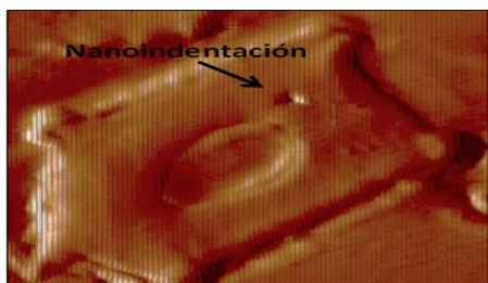
Fig. 1 Vista en 2D de una nanoindentación en la capa S2 en una fibra de pulpa Kraft cruda. Área de escaneo 10 \mu\text{m} .
